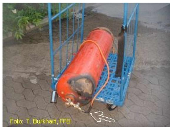
Mittels Druckknopfmelder wurde von Angestellten eines fleischverarbeitenden Betriebes die automatische Brandmeldeanlage aktiviert, da der Schlauch der Armatur einer Propangasflasche aus Versehen "durchgebrannt" wurde, sich das ausströmende Gas
